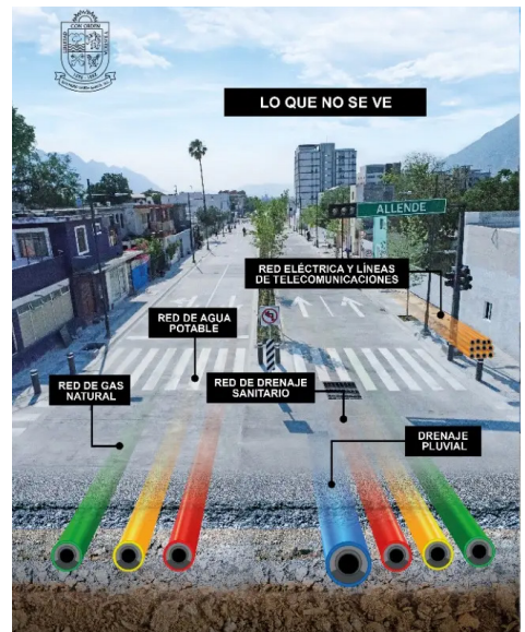
Fig 12. Infraestructura subterránea en la "Nueva Vasconcelos: Primera Etapa" Fuente: San Pedro Garza García
