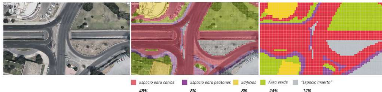
Figura 7. Identificación del porcentaje del espacio urbano ocupado en la intersección de Av. Gómez Morín y Av. José Vasconcelos
